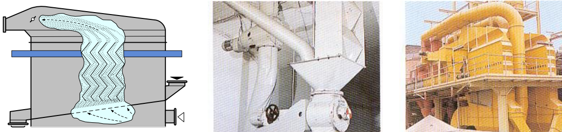
175. ábra. ALPINE cikk-cakk légáramkészülék kábelszeparálásra
