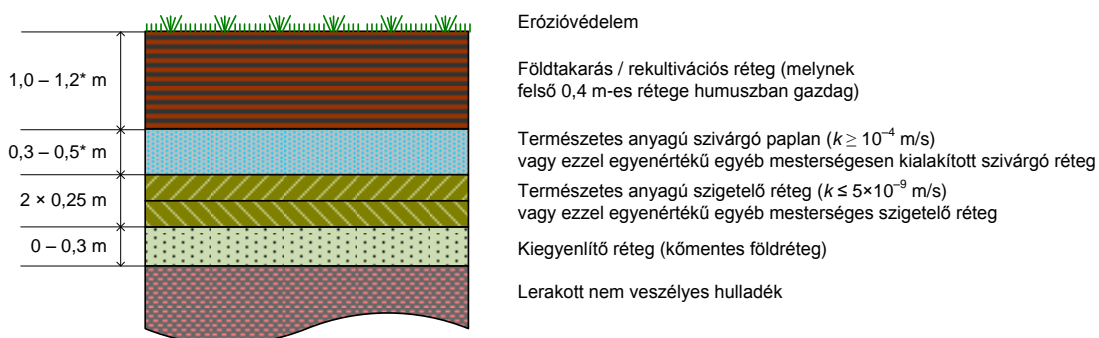
24. ábra. A nem veszélyes hulladékok lerakója (B1b kategória) felső (lezáró) szigetelésének hazai szabályozása
