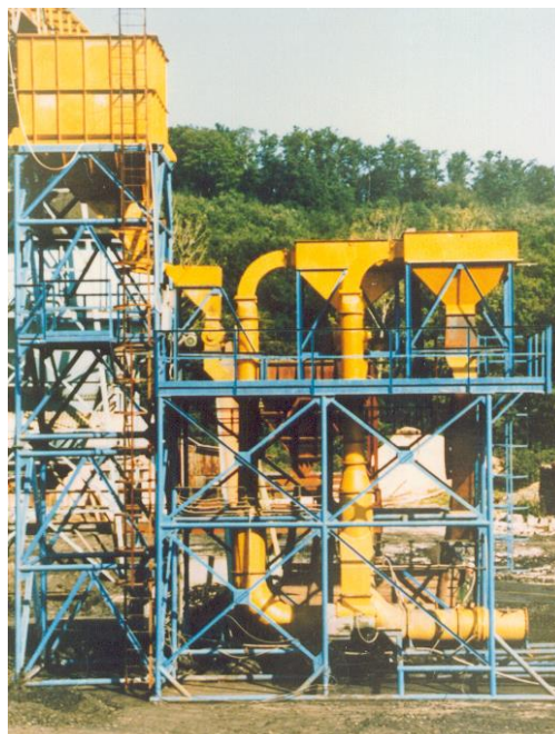
127. ábra. Ellenáramú légáramkészülék sűrűség szerinti száraz szétválasztásra (Miskolci Egyetem Eljárás technikai Tanszék által tervezett)
