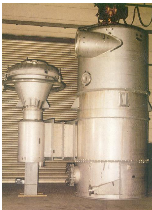
52. ábra. Ventur-mosó kialakítás és elvi működési vázlat
